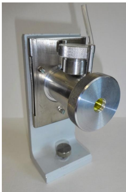
Рис. 2. Опытный образец ИК-спектрометрической ячейки
