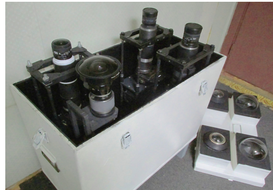
Эмиссионный имажер obs. "Ловозеро" в гермобоксе
